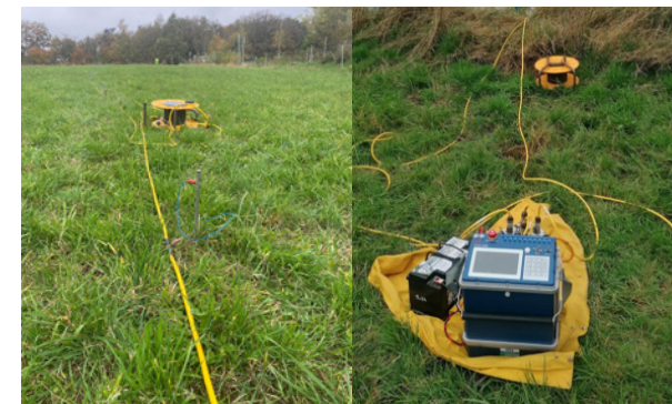
Typischer Aufbau einer Geoelektrik-Messung mit den installierten Elektroden samt verbindender Kabel (links) und das Messinstrument (rechts). Beide © KIT
