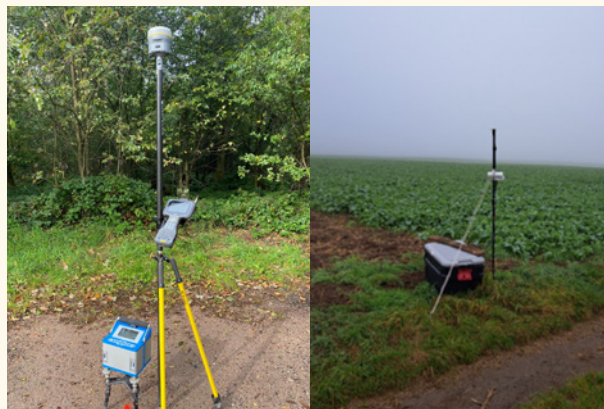
Das linke Bild zeigt eine Gravimetrie-Messung mit einer GPS-Station. Rechts wird eine Magnetik-Messung durchgeführt. Beide © KIT
